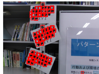
図3: 回転させた文字での検出実験結果
