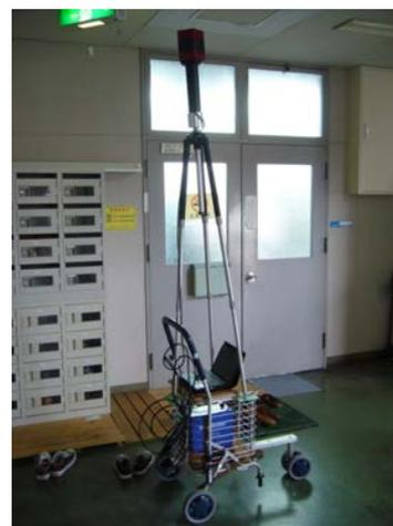
図 3 全方位カメラを用いた撮影セット
